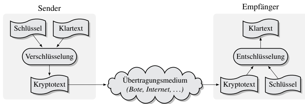
Abbildung 1.8 Dieses Kommunikationsschema zeigt den Kommunikationsschritt, bei dem die Übertragung einer verschlüsselten Nachricht gezeigt wird. Um den Klartext zu verschlüsseln oder den Kryptotext zu entschlüsseln brauchen beide Kommunikationspartner zusätzlich einen gemeinsamen geheimen Schlüssel.
