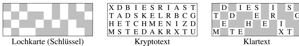
Abbildung 1.14 Das Kryptosystem RICHÉLIEU. Links ist eine Lochkarte für einen Klartext mit zwanzig Buchstaben abgebildet. Wird die Lochkarte auf den Kryptotext gelegt, der in der Mitte dargestellt ist, erhält man den Klartext, der rechts abgebildet ist.
